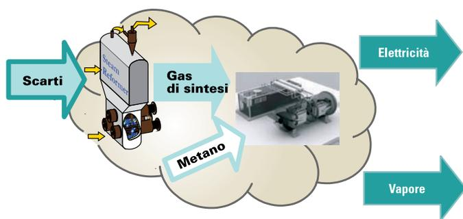
Il funzionamento delle celle a combustibile non prevede la combustione degli scarti e dei loro derivati, che vengono invece sottoposti a un processo di rigassificazione.
